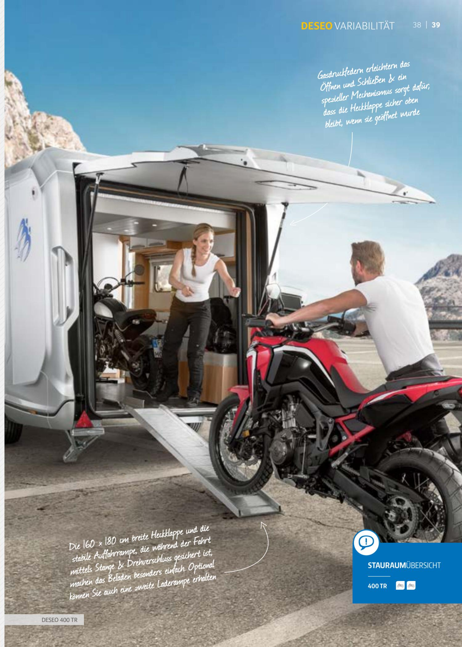
*Gasdruckfedern erleichtern das Öffnen und Schließen & ein spezieller Mechanismus sorgt dafür, dass die Heckklappe sicher oben bleibt, wenn sie geöffnet wurde*
