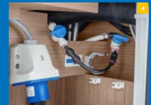
**4.** Falls kein Ersatzfilter vorhanden ist, garantiert das Zwischenstück die weitere Wasserversorgung.
