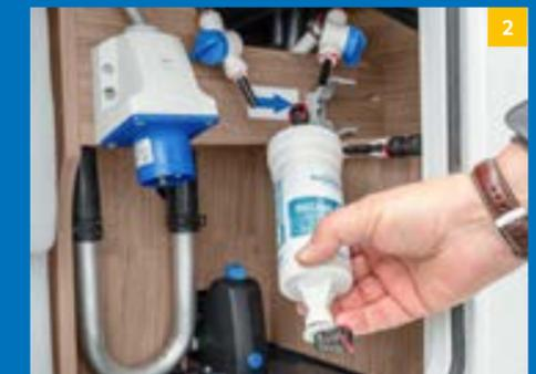
**2.** Der Einbau ist dank Steckverbindung und deutlicher Markierungen besonders einfach.
