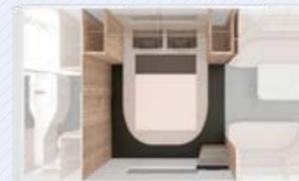
**Von beiden Seiten zugänglich.** Dank der besonderen Raumaufteilung ist das Queensbett mit 200 x 144 cm Liegefläche von beiden Seiten zugänglich und bietet einen komfortablen Durchgang zum Heckbad.
