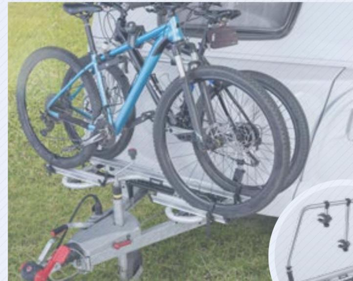
Für einen **sicheren und bedienerfreundlichen Transport** Ihrer **Fahrräder oder E-Bikes** ist der Thule Caravan SUPERB das optimale Ausstattungsfeature. Dank **Montage auf der Deichsel** und **verriegelbarer Schiebebügel** werden die Räder selbst bei schwierigen Straßen- und Windverhältnissen sicher auf ihrem Platz gehalten.
